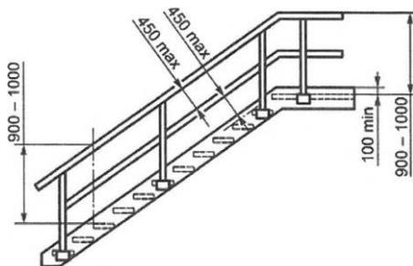
Рисунок 4. Геометрические параметры защитного ограждения маршевой лестницы.  $75^\circ$ .
