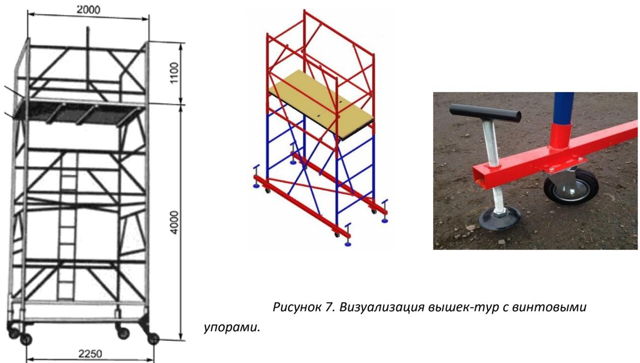
Рисунок 7. Визуализация вышек-тур с винтовыми упорами.
