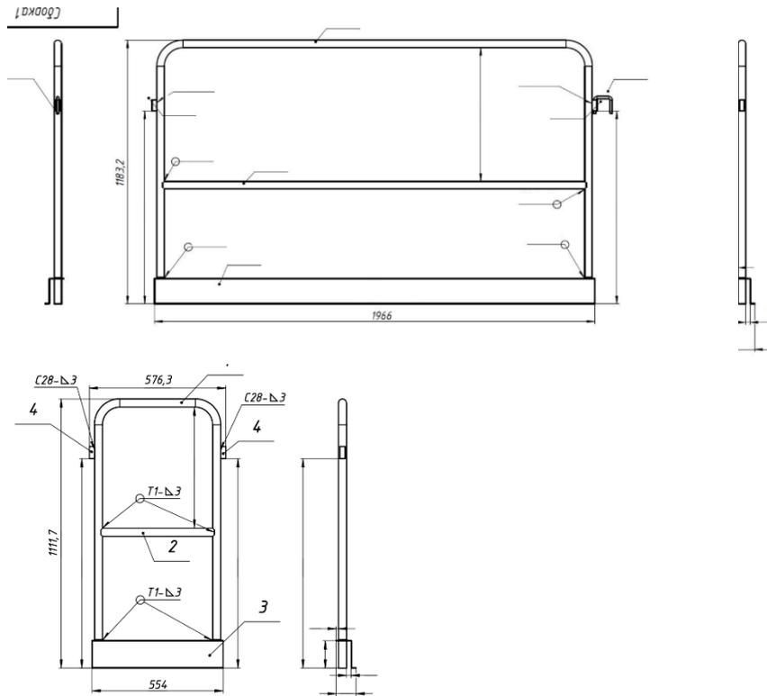
Рисунок 1. Схематичный вид защитного ограждения (с размерами).
