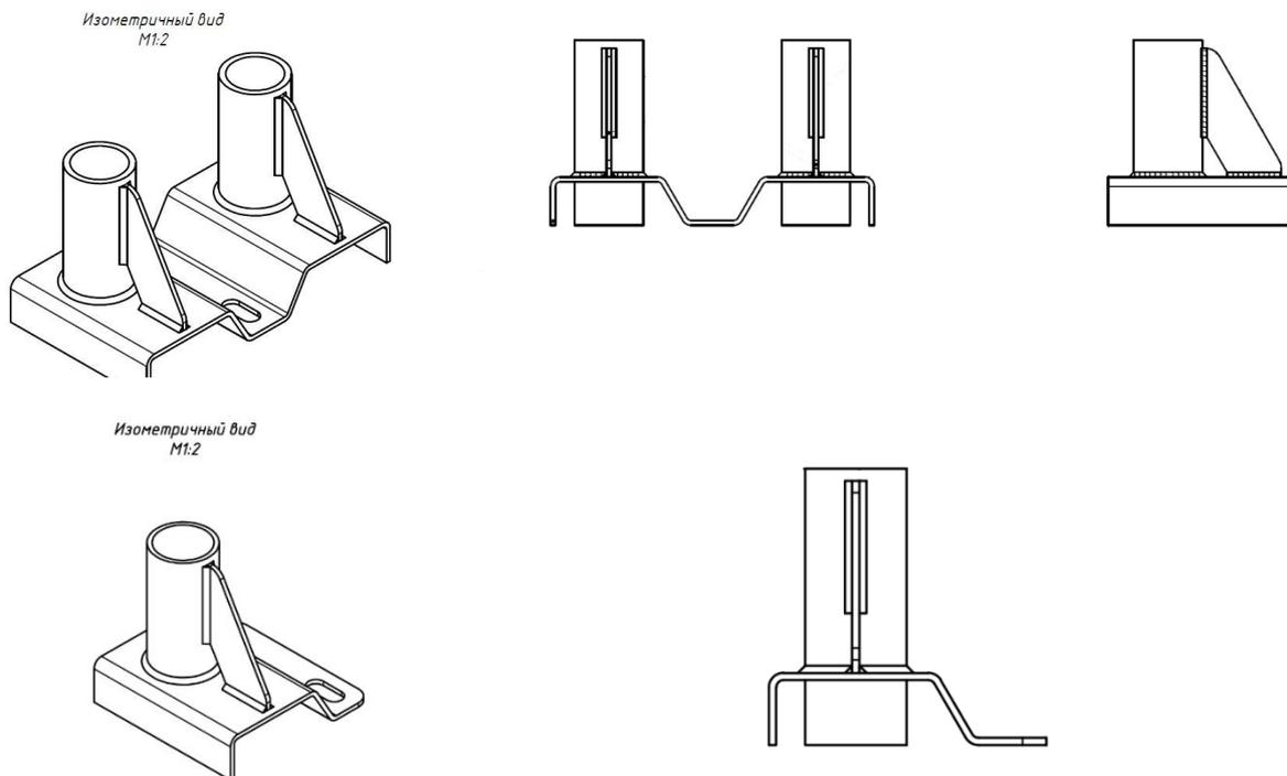
Рисунок 2. Схематичный вид основания (основание подбирается под ограждение).
