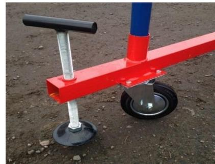
Рисунок 7. Визуализация вышек-тур с винтовыми упорами.
