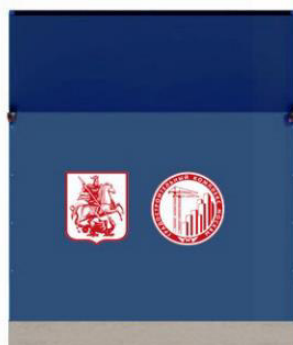
Тип 2.3 Защитно-охранное ограждение
